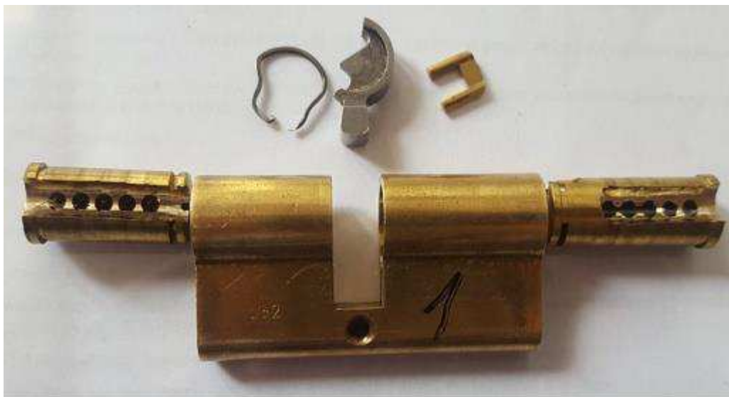
Obrázok 9 Cylindrická vložka po ukončení testu (Mach,V., 2016 )
