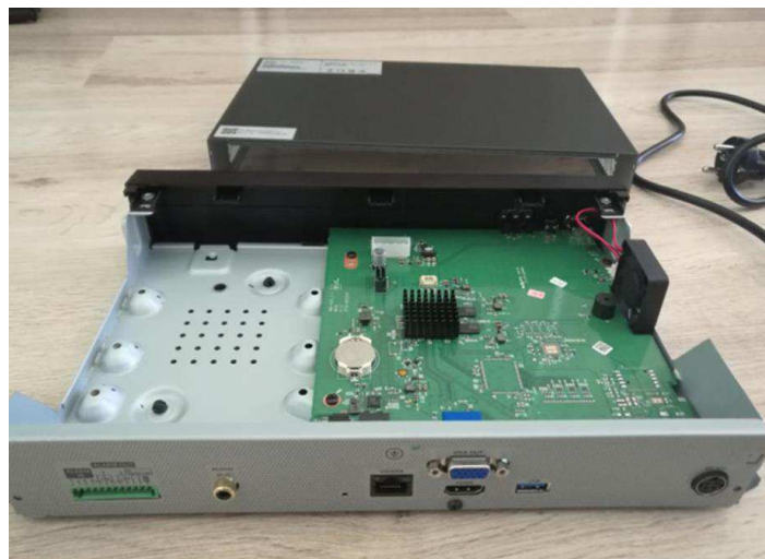
Obrázok 2 Rozobraté QRN-410 pripravené na inštaláciu disku
