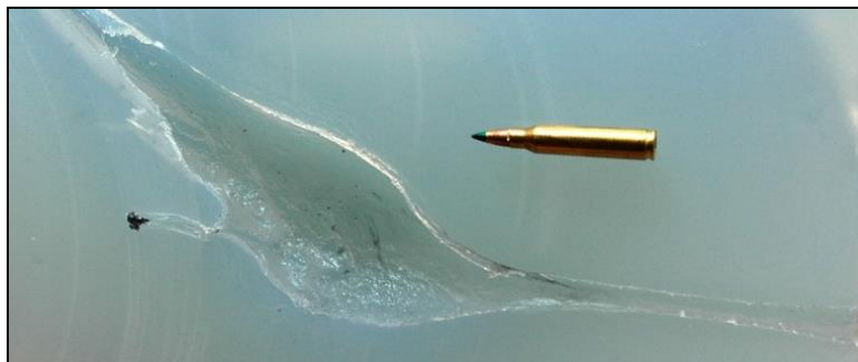
Obrázek 6. Tvorba střelného kanálu (dočasné dutiny) v mýdlovém bloku FMJ mikrorázovou střelou (ráže do 6 mm a hmotnost 3 až 4 g) puškového náboje ráže 5,56x45
