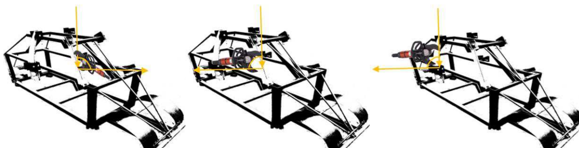
Obrázok 5 Zobrazenie správneho prístupu strihania A stĺpika (vľavo) a B stĺpika (vpravo)
