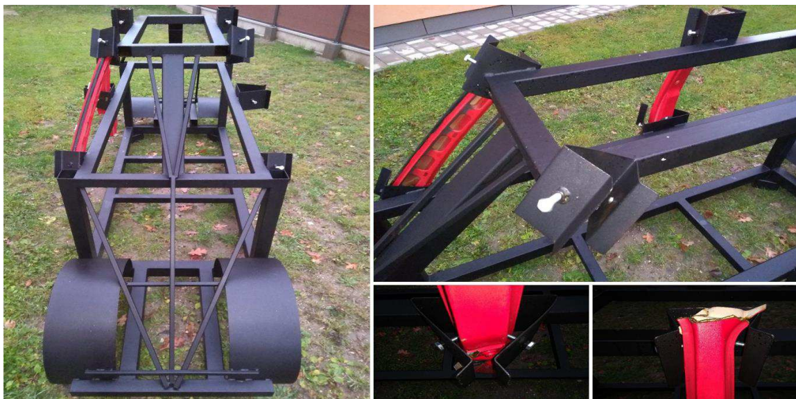
Obrázok 3 Konštrukcia prototypu výcvikového zariadenia
