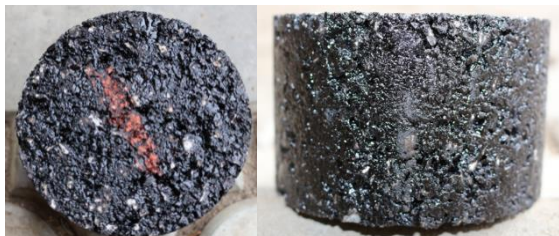
Obrázok 1 Vzorka asfaltového betónu AC 11 O 50/70; II; V-5 [18]
