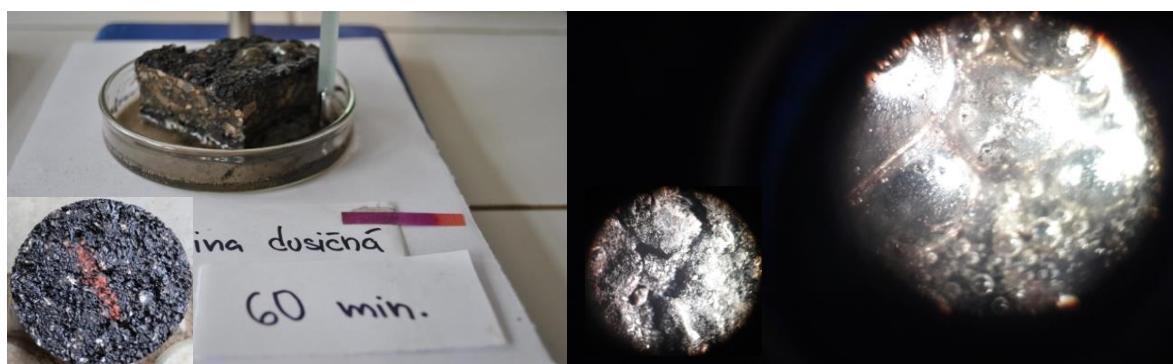
Obrázok 3 Deštrukcia asfaltovej vzorky po aplikácii CHNL – HNO 3 po uplynutí 60 min. [18]
