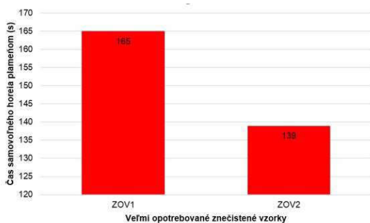
Obrázok 7 Čas samovoľného horenia plameňom pre vzorky ZOV1 a ZOV2
