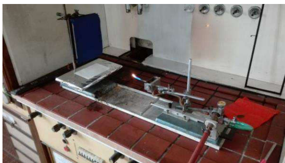
Obrázok 4 Skúšobné zariadenie podľa normy STN EN ISO 6940 [5]
