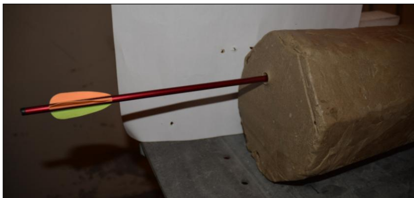
Obrázek 2. Zástřel duralovým šípem s ocelovým hrotem délky 14“ HalfMoon ve zkušebním bloku vyrobeném z plastelíny (PL).
