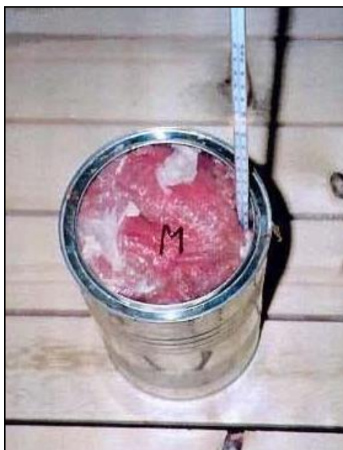
Obrázek 4. Měření teploty zkušebního vzorku vepřového masa (M) před experimentem
