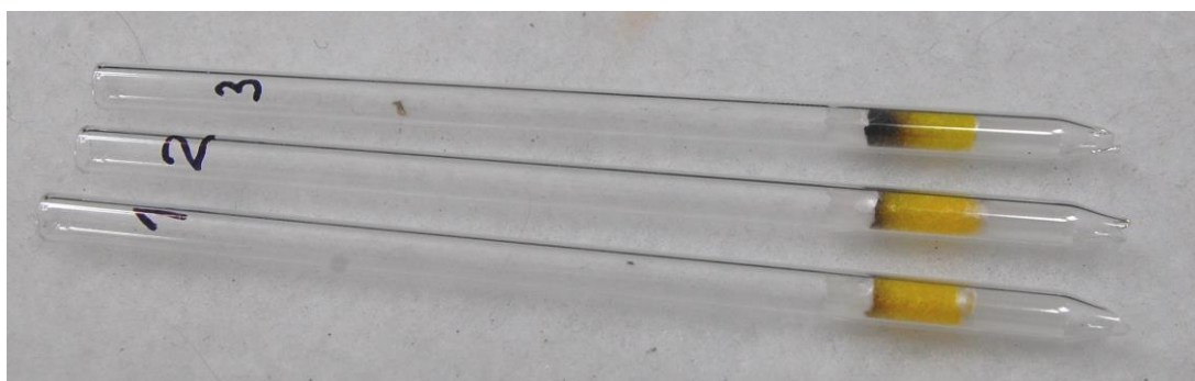
Obrázek 2. Kolorimetrické trubičkové detektory exponované MeS o koncentraci 60 \text{mg.m}^{-3} (1), 120 \text{mg.m}^{-3} (2) a 600 \text{mg.m}^{-3} (3). Objem vzorku 1 \text{dm}^3 .
