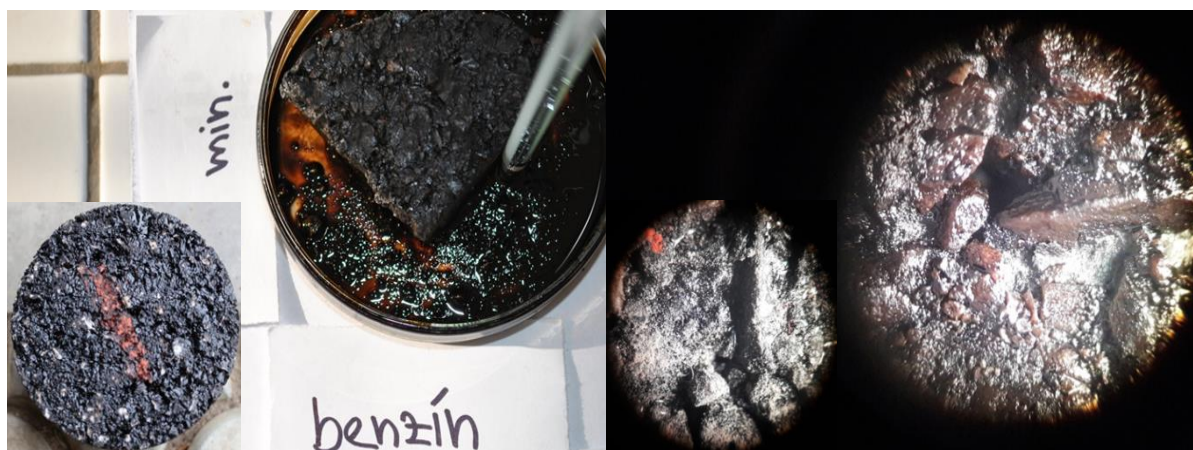
Obrázok 2 Deštrukcia asfaltovej vzorky po aplikácii CHNL – benzínu po uplynutí 60 min. [18]
